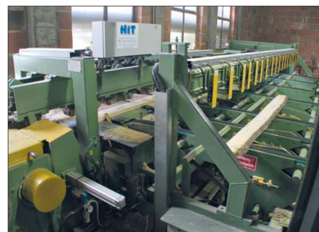
Neu im Programm von HIT: Ein Säumer, an dem mit 30 Takten/min 1 bis 6 m lange Bretter bis zu einer Stärke von 60 mm und einer Breite bis 55 cm verarbeitet werden.
