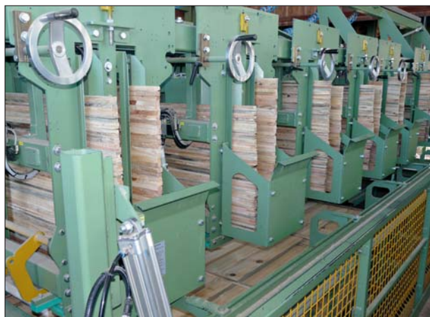
Stapelautomat mit Doppel-Lattenmagazin für unterschiedliche Lattendimensionen
