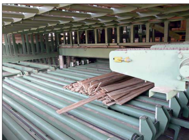
Heb- und senkbarer Rollen-Querförderer unter dem BrettSortierwerk: Höhenunterschiede der Anlagenteile werden so ausgeglichen. Von hier aus geht die Ware zur Paketierung.
